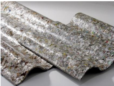
Tejas de tetra Pack. Aluminio y polietileno se pican y compactan.
